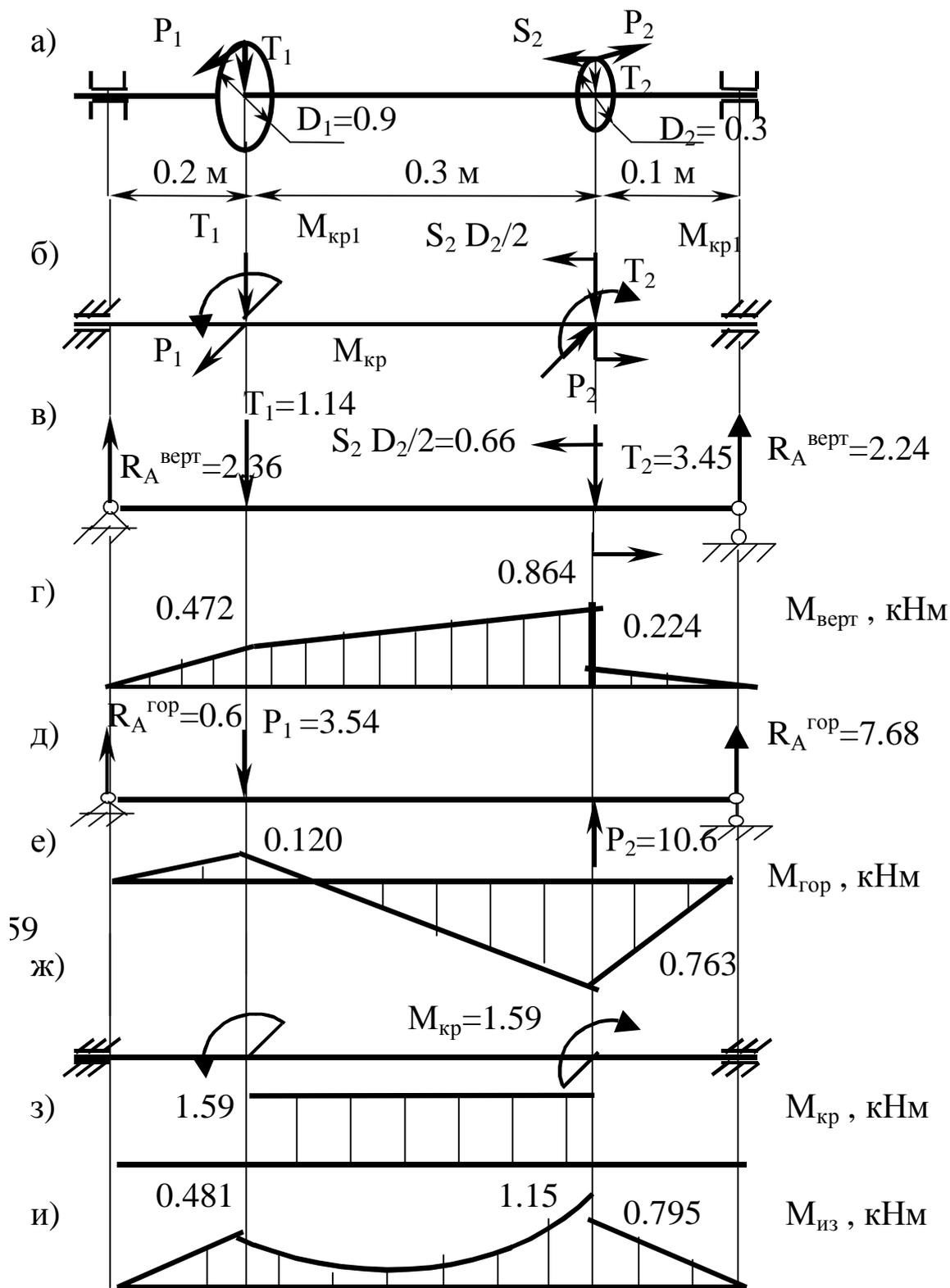
а – схема вала; б -приведение всех сил к оси вала; в – си лы, действу ющие на вал, в вертикальной плоскости; г – эпюра изгибающих мо ментов  $M_{верт}$ , д - си лы, действу ющие на вал, в горизонтальной плос кости; е - эпюра изгибающих моментов  $M_{гор}$ , ж -моменты, скручи ва ющие вал; з -эпюра крутящих моментов  $M_{кр}$ ; и – суммар ная эпюра изгибающих моментов.
