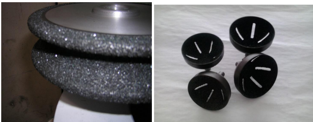
a – круги формы 2FF6; б – круги формы 1F1W Рис. 1. Инструмент для шлифования изделий из поролона
