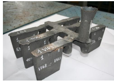
Рисунок 1 – Загальний вигляд нижньої півформи для виготовлення експериментальних виливків (а) і блока отриманих виливків із ливниково-модифікувальною системою (б)
