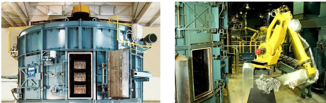
Рисунок 2 – Термическая печь с вращающимся подом и загрузка роботом такой печи отливками в 3 ряда
