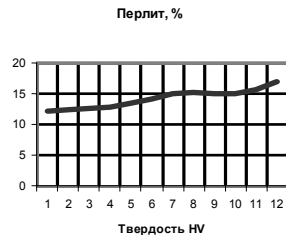
Рисунок 5 – Зависимость «твердость – перлит»
