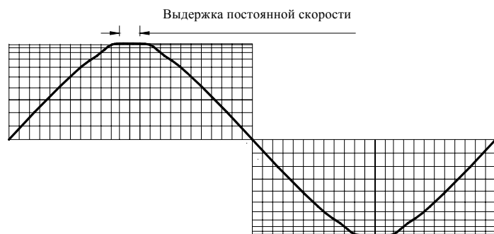
Рисунок 4 — График нагрузки гидrogасителя колебаний с выдержкой при постоянной скорости на вершинах синусоиды
