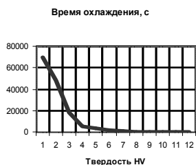
Рисунок 3 – Зависимость «твердость – время охлаждения»
