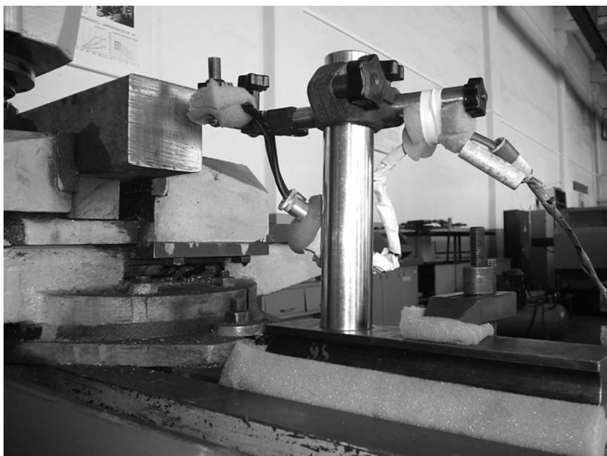
Рисунок 2 – Схема закрепления световолоконного датчика микроперемещений
