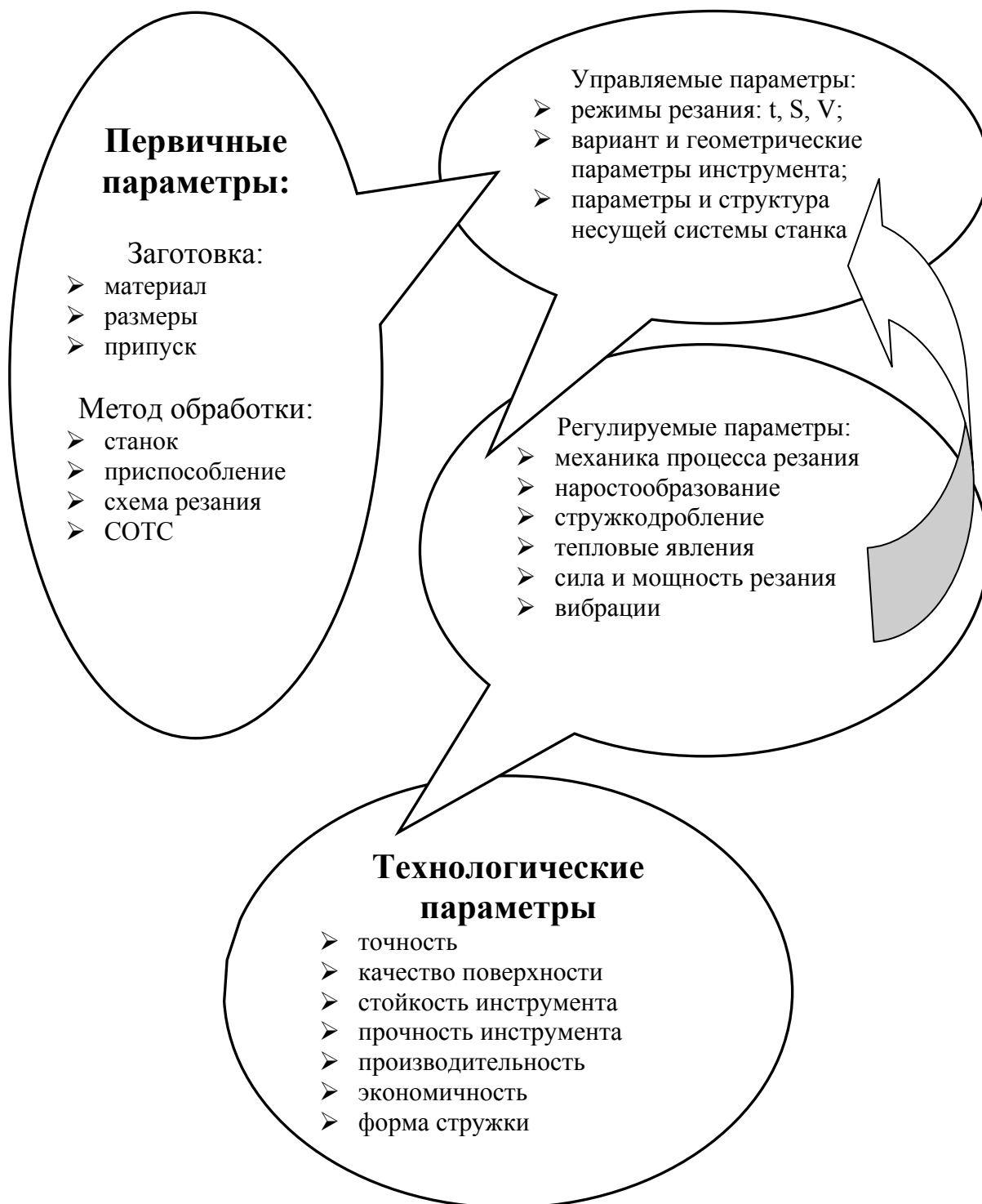
Рисунок 1 – Схема регулирования процесса обработки
