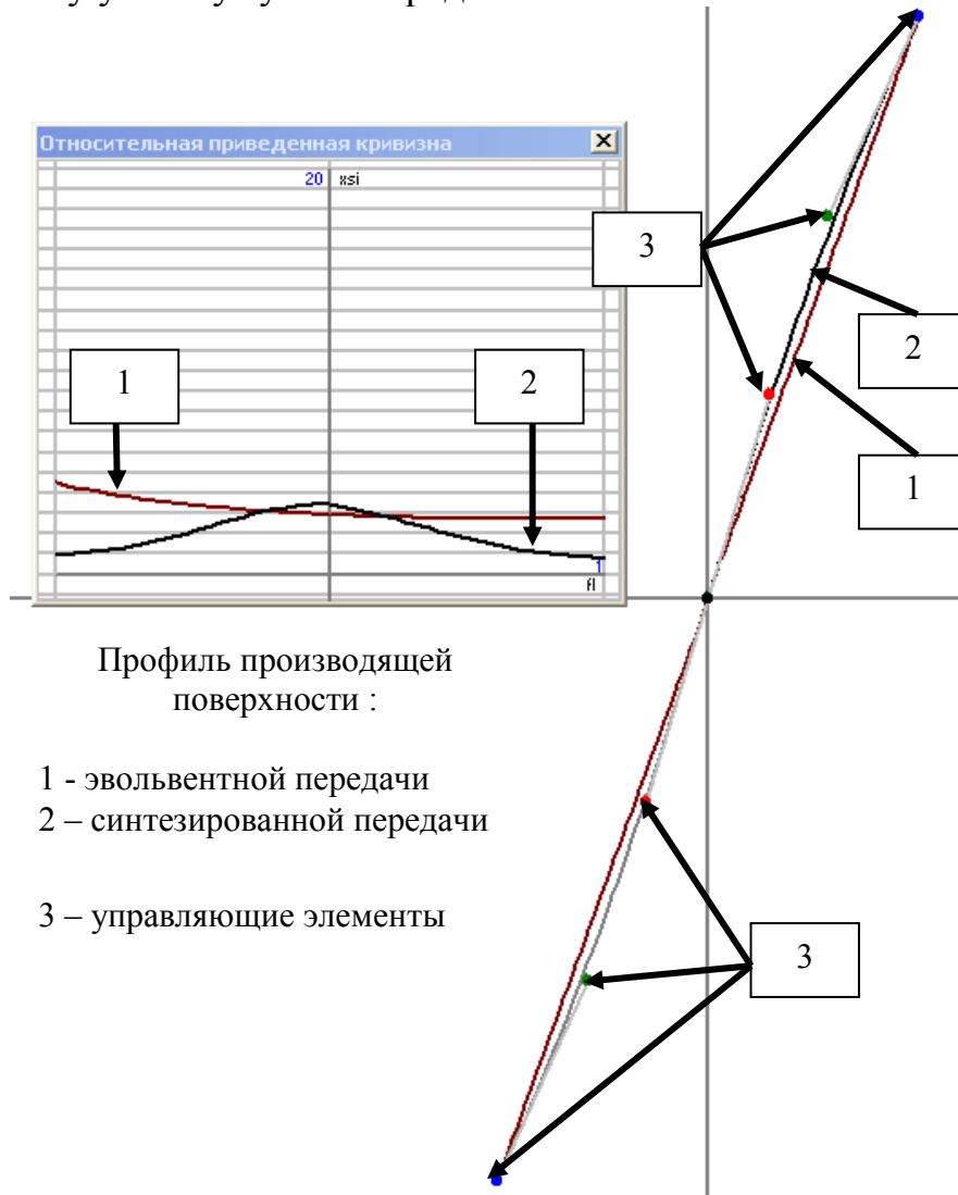
Рисунок 2 – Пример визуального динамического синтеза зубчатой пары редуктора
