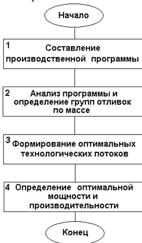
Рисунок 1 – Схема алгоритма определения оптимальной структуры и мощности литейного цеха
