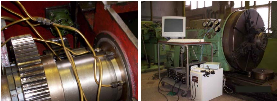
Рисунок 2 – Станок-стенд для испытаний гидростатических шпиндельных опор
