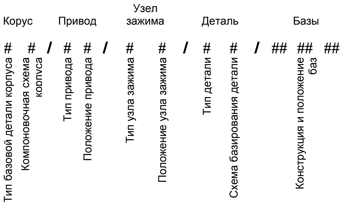
Рисунок 7 – Схема кодирования УЗП АС
