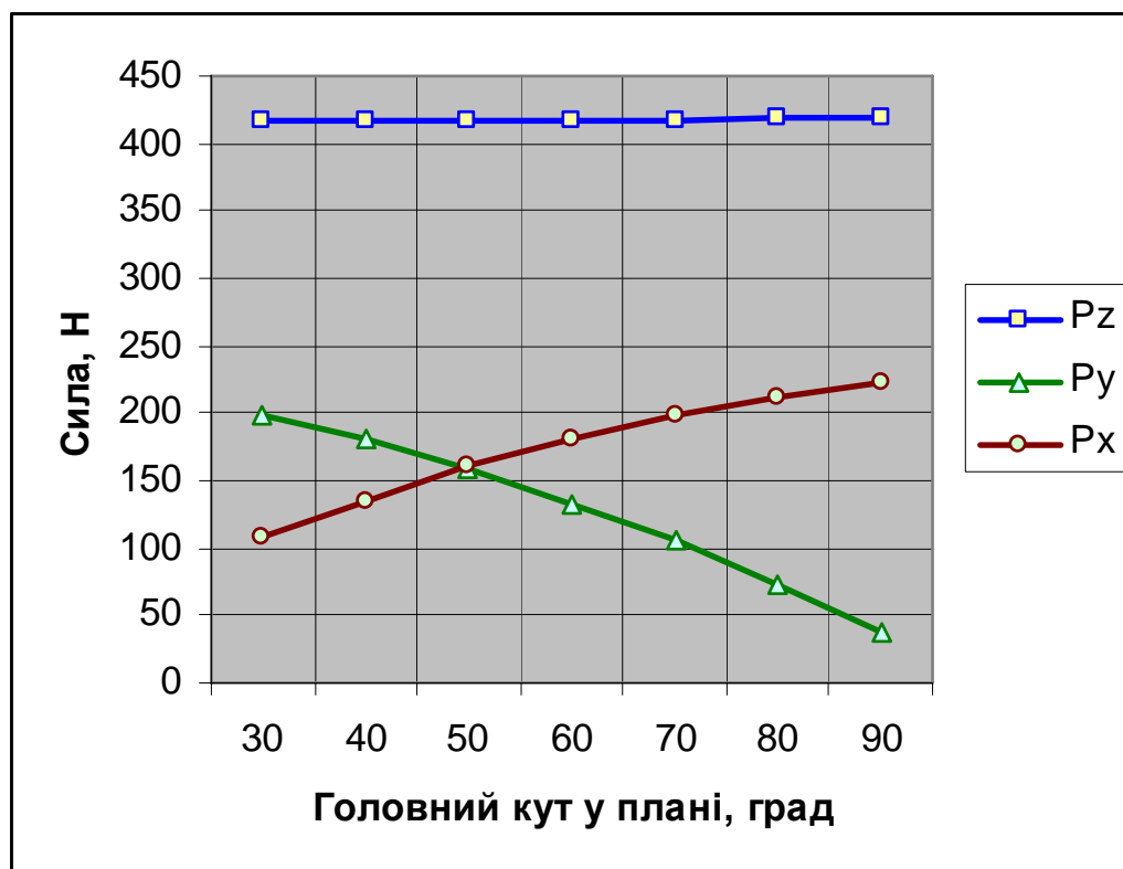
Рисунок 6 – Залежність складових сили різання від кута \varphi у плані
