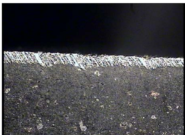
Рисунок 4 – Фаска износа на задней поверхности інструмента (x280)
