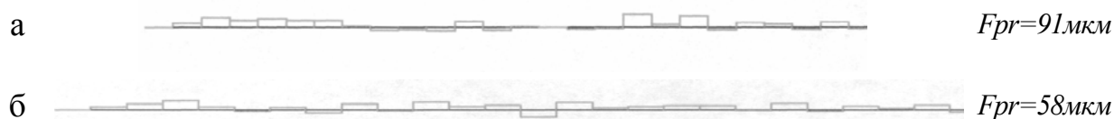
Рисунок 5 – Диаграмма измеренной накопленной ошибки шага колеса F_{pr} нарезанных: стандартной фрезой а), фрезой предложенной конструкции б).
