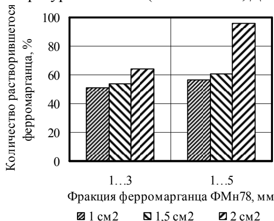
Рисунок 5 – Влияние фракции ферромарганца ФМн78 на его растворимость при различной величине площади сечения литникового хода ( T_{зал.} = 1470^\circ\text{C} , ДСПРК = 0,25).
