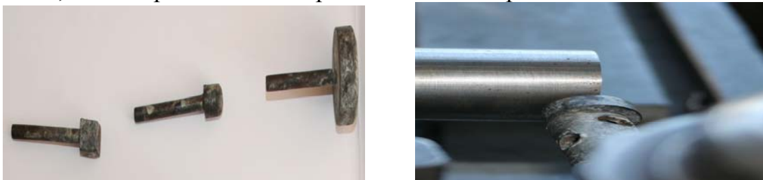
Рисунок 4 – Инденторы и схема деформирования оболочки а- инденторы; б- схема деформирования оболочки индентором
