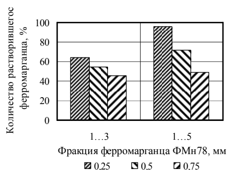
Рисунок 6 – Влияние фракции ферромарганца ФМн78 на его растворение при различной доли свободного пространства реакционной камеры ( T_{зал.} = 1470^{\circ}C , и F_{л.х.} = 2 \text{ см}^2 ).
