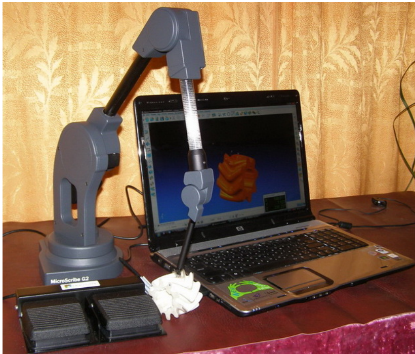
Рисунок 1 – Использование КИМ MicroScribe G2
