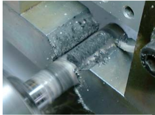
Рисунок 2 – Магнітно-абразивна обробка циліндричної заготовки
