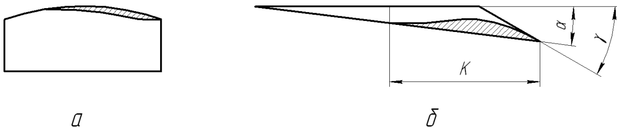
Рисунок 4 – Схема зношення кулачка та спіралі Архімеда
