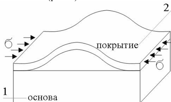
Рисунок 1 – Разрушение покрытия под воздействием остаточных напряжений сжатия
