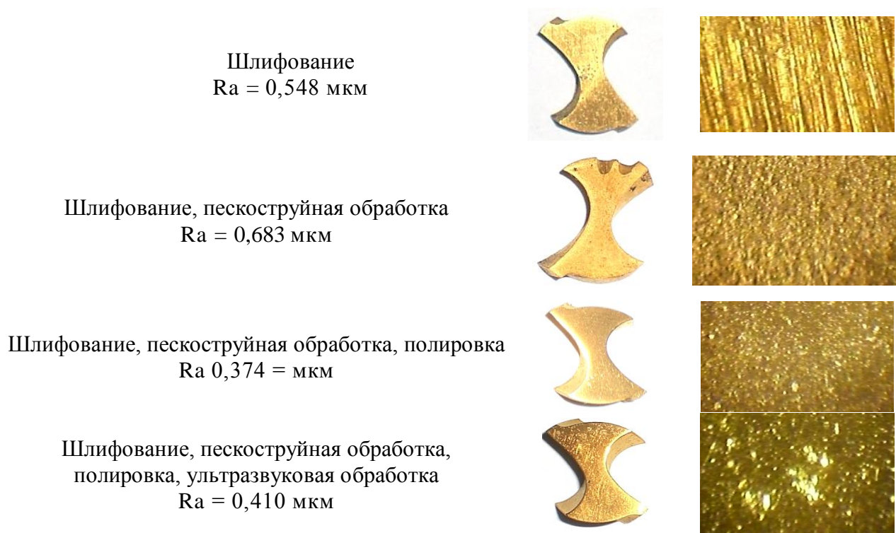
Рис. 1. - Поверхность образцов с вакуумными ионно-плазменными покрытиями, нанесенными после различных операций комбинированной отделочной обработки спиральных сверл (увеличение \times 50 )
