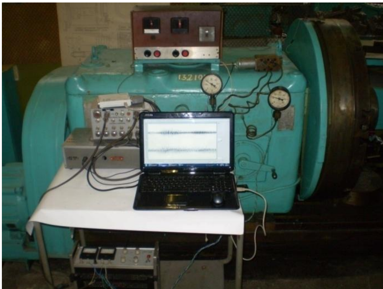
Рис. 4 - Загальний вид верстата-стенда, оснащеного системою адаптивного керування
