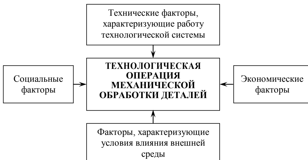
Рис. 1 - Факторы, влияющие на формирование структуры технологической операции механической обработки деталей
