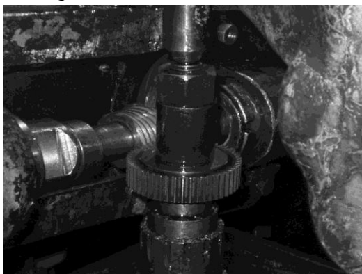
Рис.3 - Накатывание прямозубого накатника.
