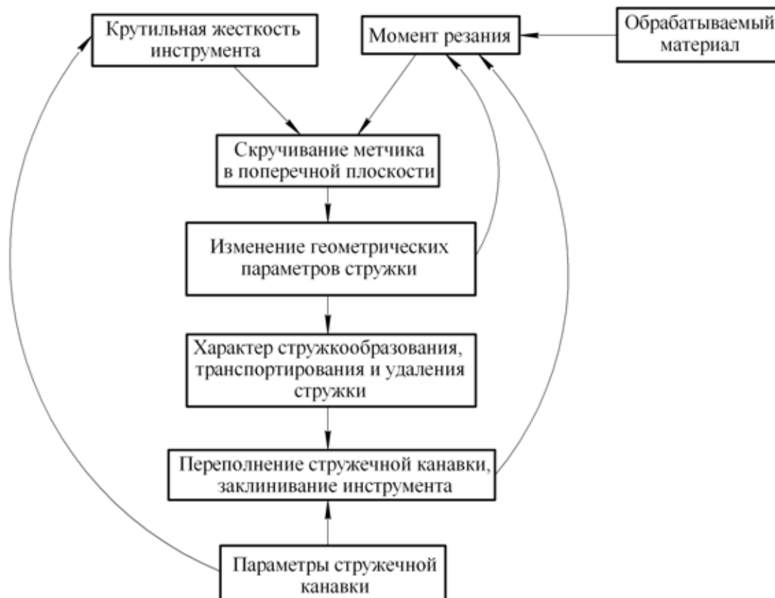
Рис. 6 – Схема взаимосвязи элементов процесса резбонарезания при скручивании метчика
