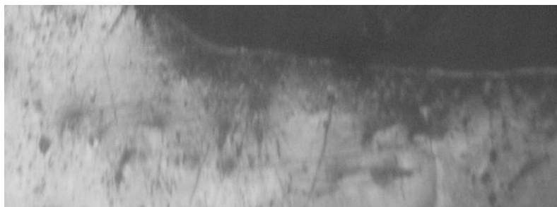
Рис. 2. Микроструктура обработанной поверхности заготовки из стали 12X18H12T (увеличение \times 200 )
