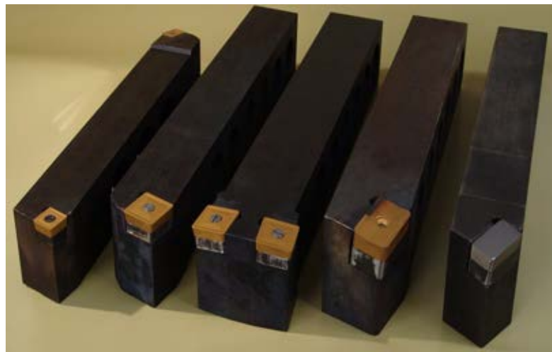
Рис. 1 – Резцы для тяжелого точения с креплением винтом и рычагом за отверстие. Пластины SNMM 38 и LNUX 50
