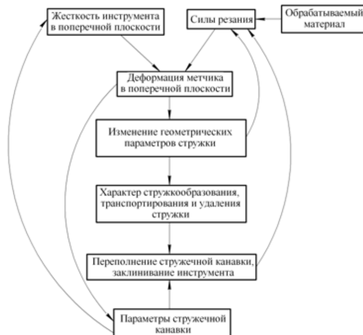
Рис. 2 – Схема взаимосвязи элементов процесса резбонарезания при поперечных деформациях инструмента
