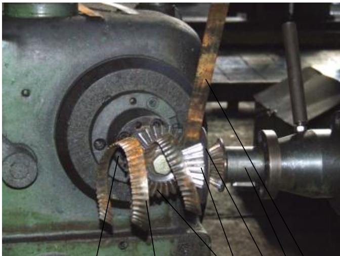
а) 1-заготовка; 2-ведучий шпindel; 3-упорне кільце; 4-пара конічних зубчастих коліс; 5-гвинтова гофрована заготовка; 6-ведений шпindel
