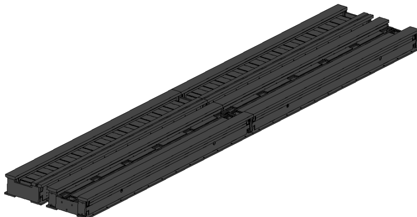
Рис. 3. Твёрдотельная модель станины тяжелого токарного станка
