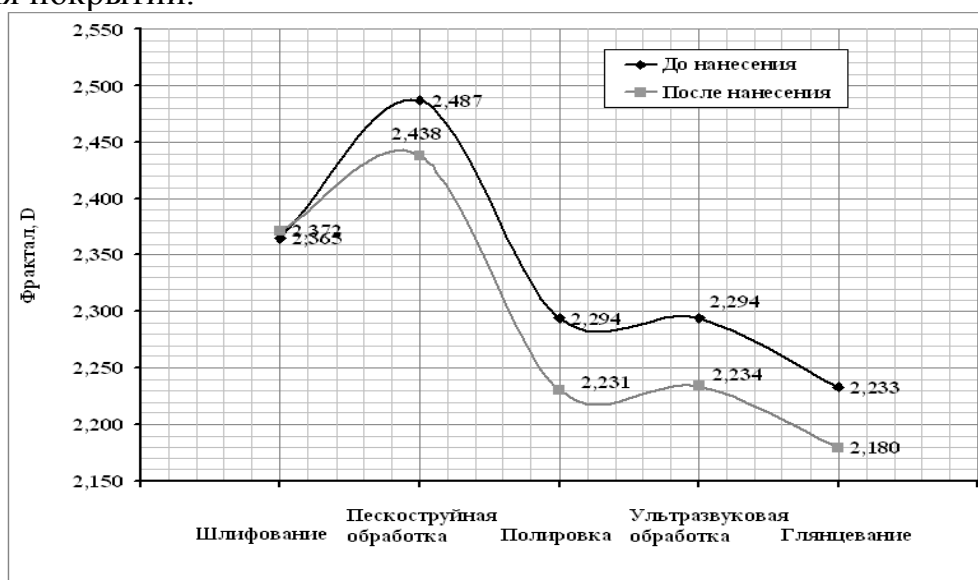
Рис. 2 - Влияние состояния поверхности и нанесения покрытий на фрактальную размерность микрорельефа поверхностей по операциям комбинированной отделочной обработки осевых лезвийных инструментов
