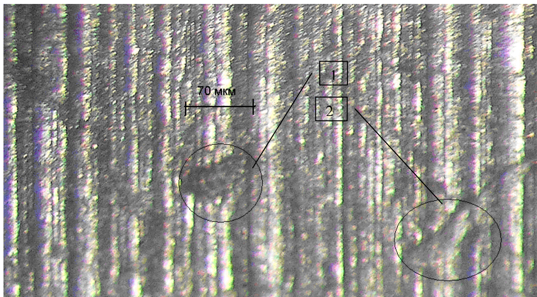
Рис. 4 - Поверхность притира со следами 1, 2 от шаржирования зерен свободного абразива.
