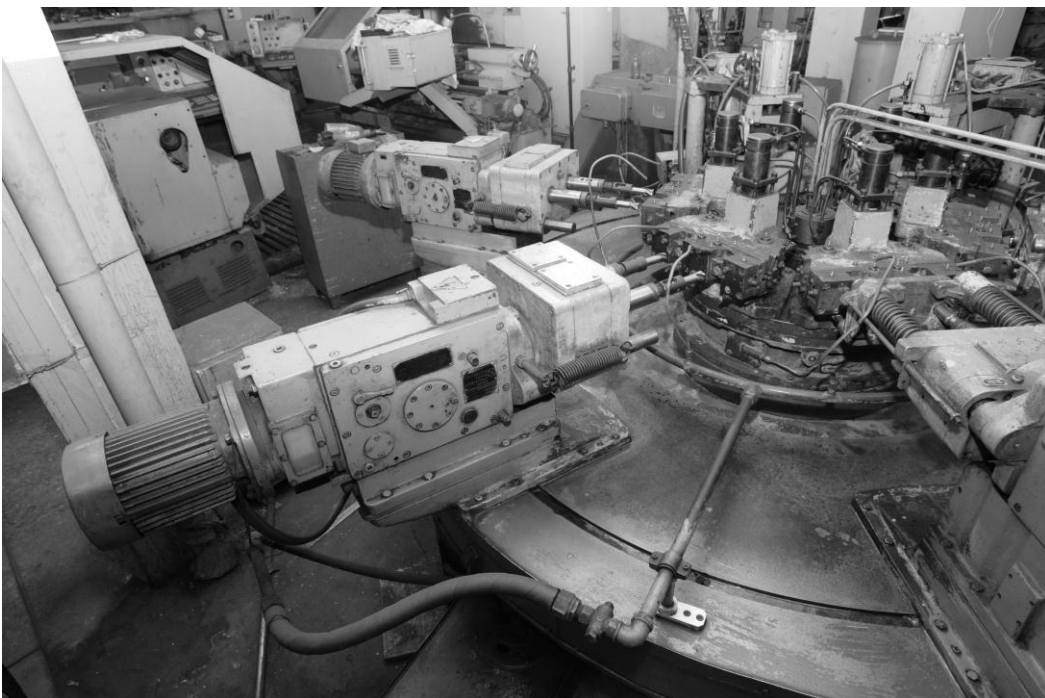
Рис. 2 - Агрегатные станки вертикальной и горизонтальной компоновок
