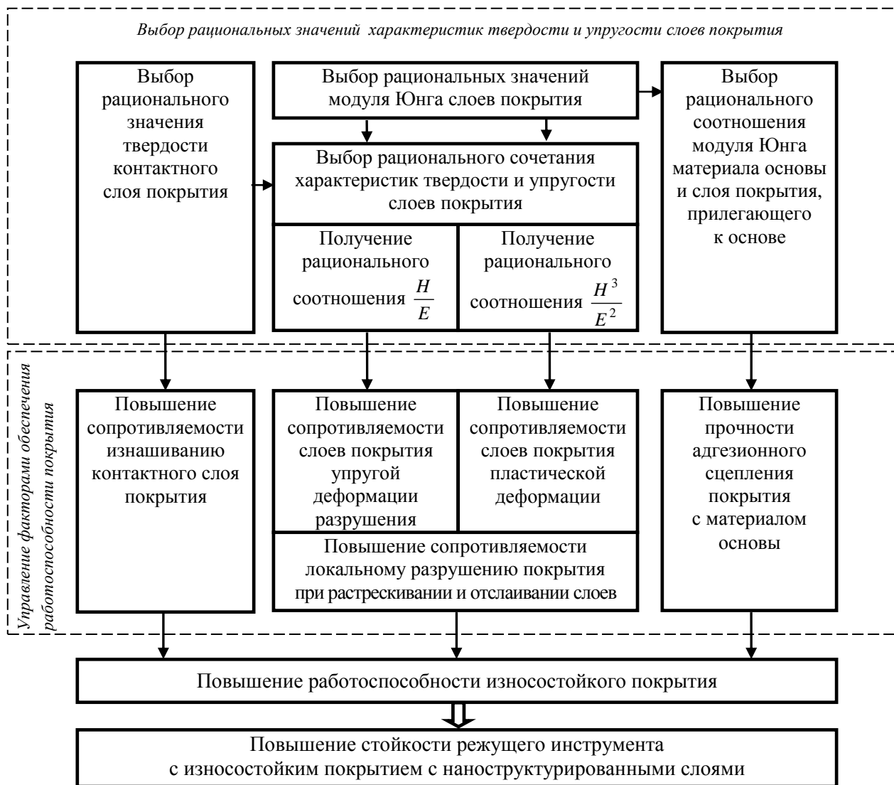
Рис. 3 – Общая схема физической модели повышения стойкости инструмента с износостойким покрытием с наноструктурированными слоями за счет выбора рационального соотношения характеристик твердости и упругости материалов слоев
