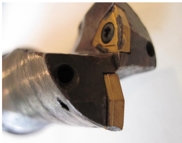
Рис. 1 – Зношування різальних пластин збірного свердла
