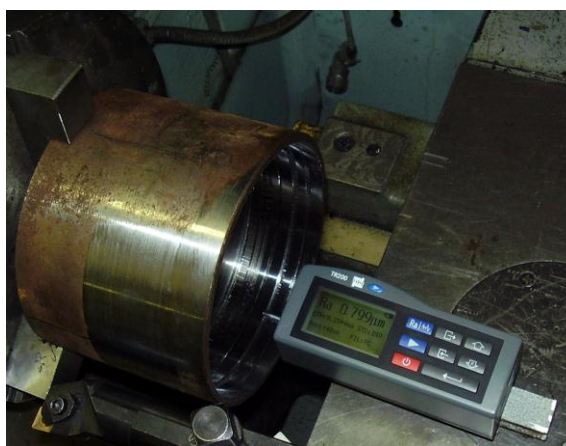
Рис. 3 - Портативный измеритель шероховатости TR200.
