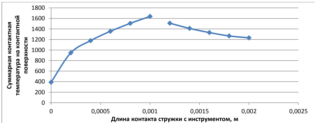
Рис. 3 - Зависимость суммарной контактной температуры на передней поверхности резца от длины контакта стружки с инструментом
