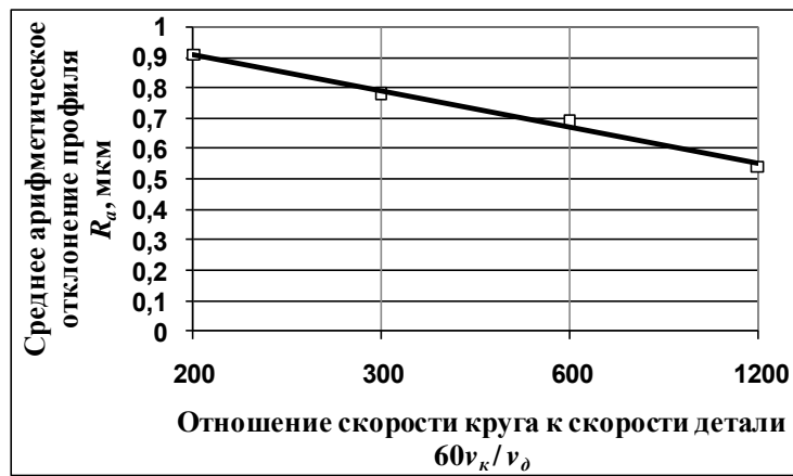
Рис. 2 – Влияние отношения скорости круга v_k к скорости детали v_d на параметры шероховатости шлифованной поверхности при плоском врезном алмазном шлифовании стали Р6М5Ф3 кругом 1А1 250×76×15×5 АС6 160/125-4-М2-01 по экспериментальным данным
