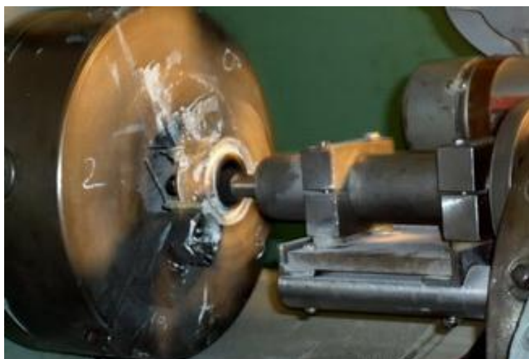
Рис. 1 – Устройство для экспериментальных исследований МАО внутренних поверхностей на базе токарно-револьверного станка 1341
