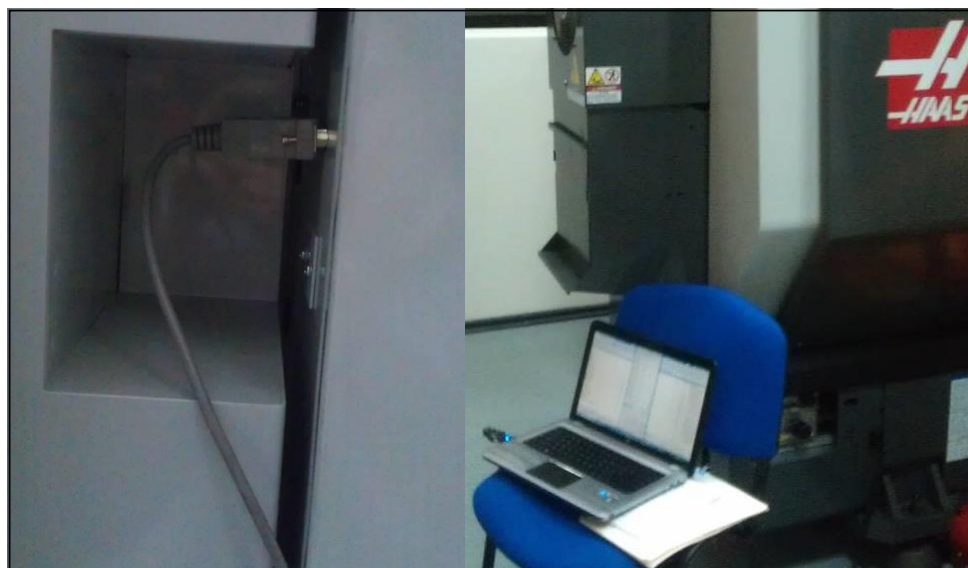
Рис.3. Підключення ПК до токарного обробляючого центру ST20 HAAS
