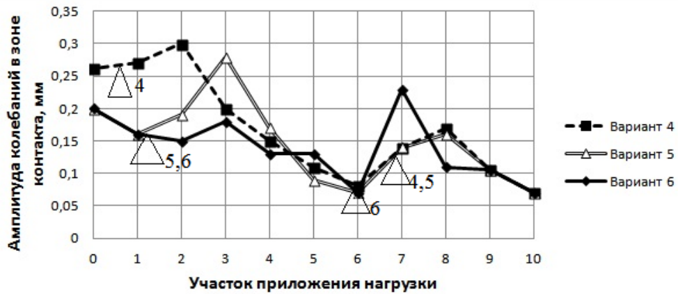
Рис. 3. Изменение амплитуды колебаний в зоне контакта круга и заготовки вдоль оси заготовки для вариантов 4, 5, 6
