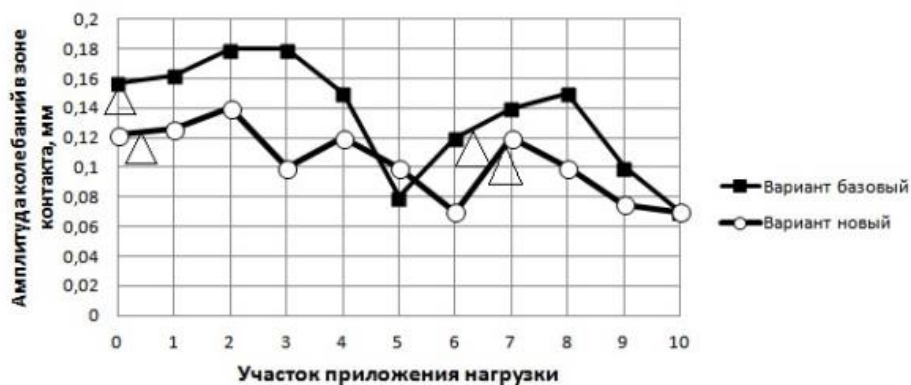
Рис. 7. Изменение амплитуды колебаний в зоне контакта круга и заготовки вдоль оси заготовки для конструкции оправок «базовой» и «новой»
