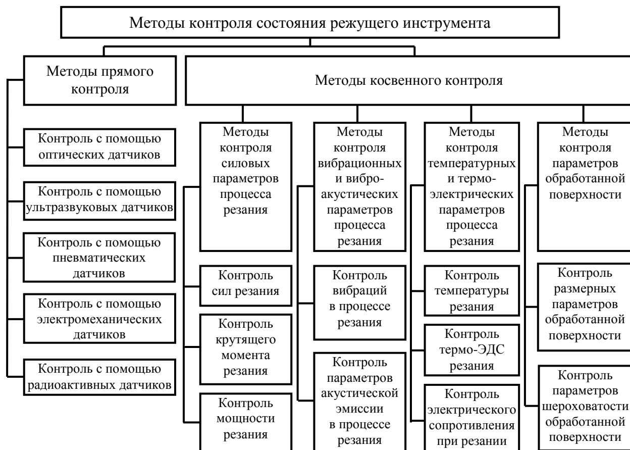
Рис. 1. Общая схема классификации методов контроля состояния режущего инструмента в современной механической обработке
