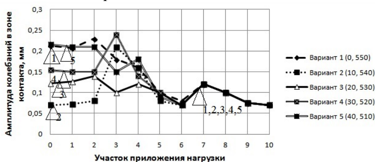
Рис. 5. Изменение амплитуды колебаний в зоне контакта круга и заготовки вдоль оси заготовки для условий в таблице 2
