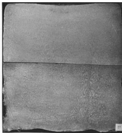
Рис. 1. Макроструктура центрального продольного темплета слитка, выполненного способом ЭШП без затравки (сталь 35)
