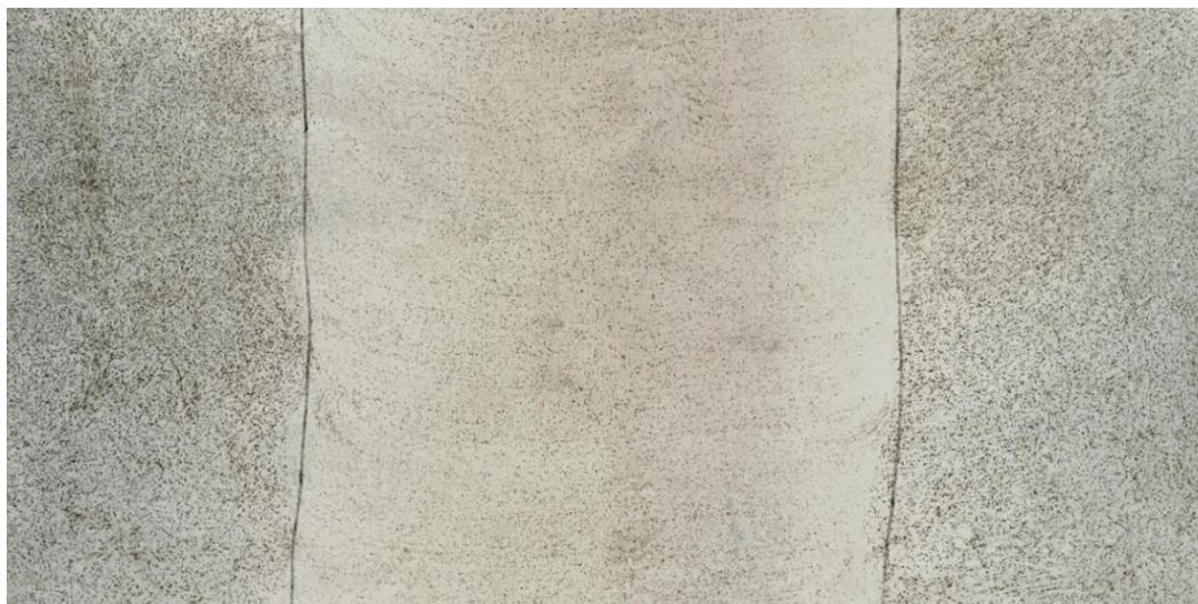
Рис. 4 – Макроструктура електрошлакового з'єднання зі сталі 40XН2МА (x100)
