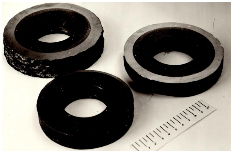
Рис. 3 – Поперечні темплети сталій заготовки, наплавлені експериментальною порошковою проволокою складної конструкції
