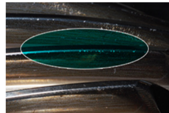
Образование пittingов на поверхности зуба колеса
