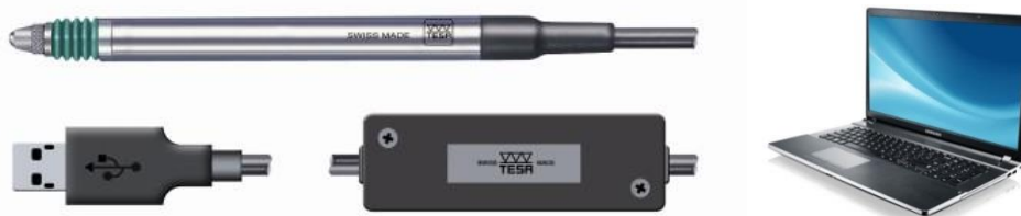
Рис. 5 Датчики линейных перемещений с USB связью с ноутбуком
