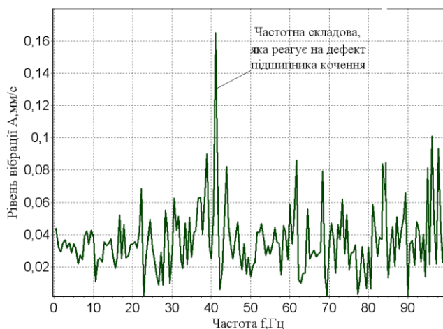
Рис.3 – Приклад спектру вібрації передньої опори шпинделя
