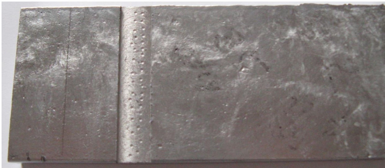
Рис. 1. Експериментальний зразок із замірами твердості профрезерованої площини
