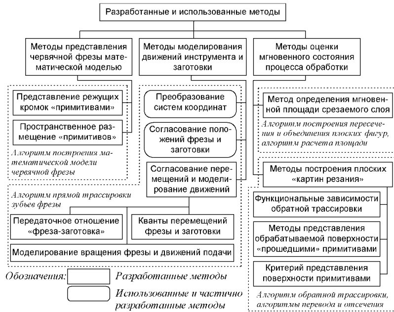
Рис. 8. Схема разработанных методов и алгоритмов моделирования обработки ЗК
