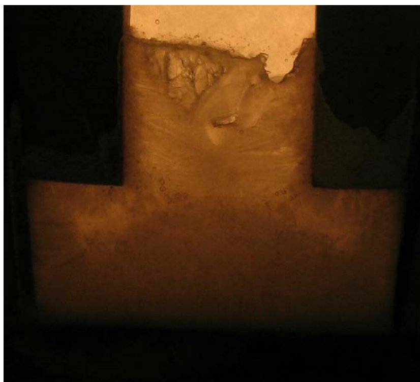
Рис. 2. Макроструктура нового зливку, отримана при моделюванні процесу затвердіння на прозорих моделях
