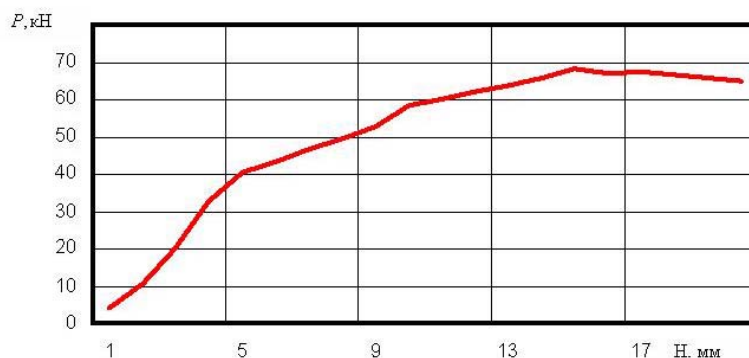
Рис. 2. График изменения усилий от хода процесса для обратного-прямого выдавливания свинца
