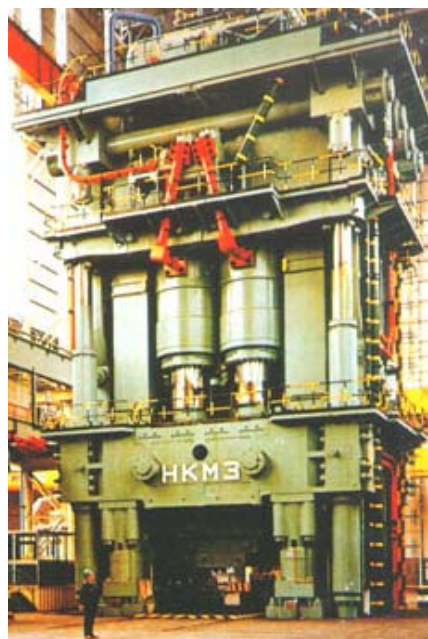
Рис. 1. Общий вид штамповочного гидравлического пресса усилием 650 МН
