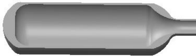
Рис. 1. Эскиз баллона высокого давления
