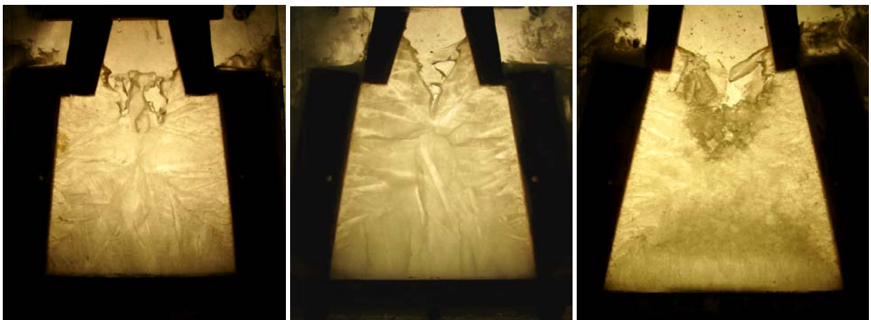
Рис. 2. Отлитые образцы с соотношением H/D = 0,5 и различной конусностью: а – 7 %; б – 14 %; в – 21 %
