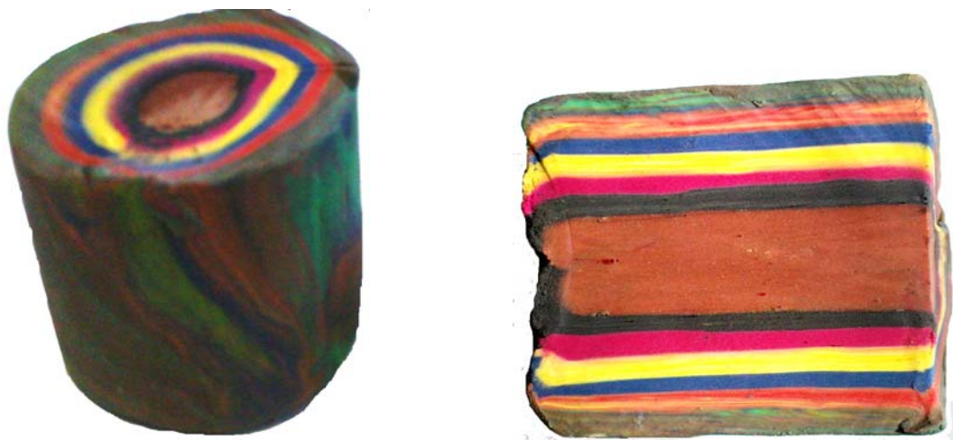
Рис. 3. Образец из пластилина до деформирования
