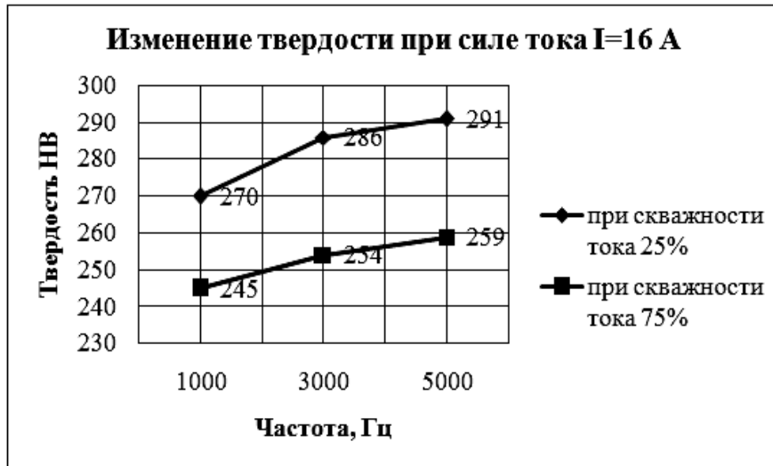
Рис. 4. Зависимость твердости от частоты импульсного тока при различной скважности (при упрочнении марганцем)
