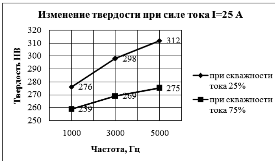
Рис. 2. Зависимость твердости от частоты импульсного тока при различной скважности (при упрочнении хромом)
