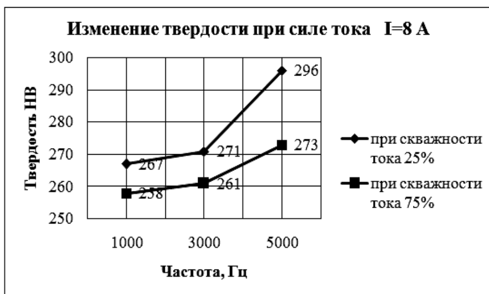
Рис. 3. Зависимость твердости от частоты импульсного тока при различной скважности (при упрочнении бором)
