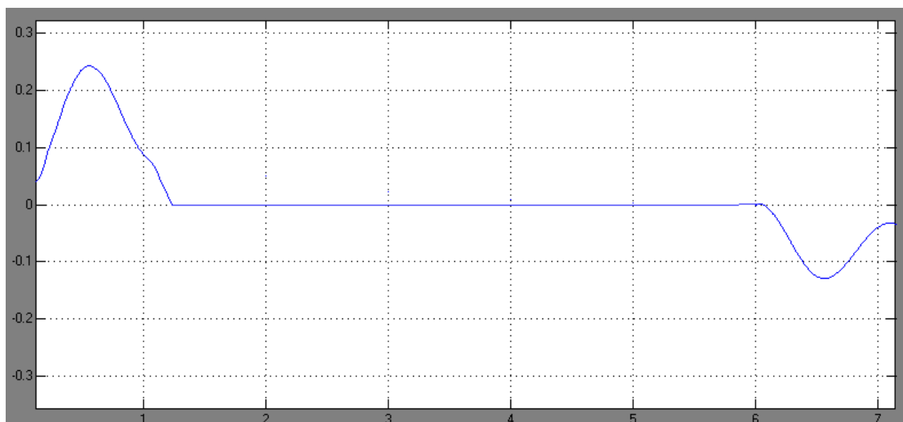
Рис. 5. График угла отклонения груза за рабочий цикл
