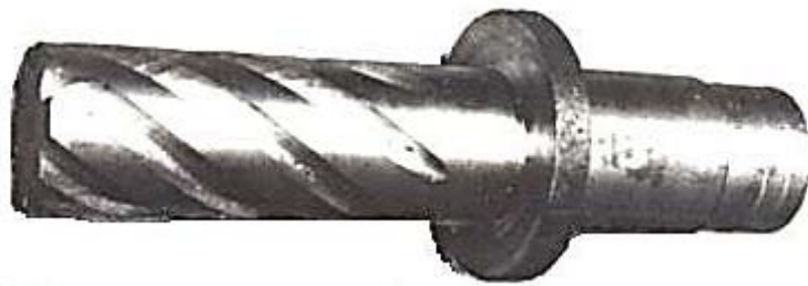
Рис. 1. Профиль канавки концевой фрезы под наплавку
