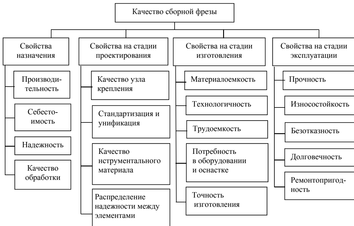
Рис. 1. Структура комплексных свойств, составляющих качество сборной фрезы
