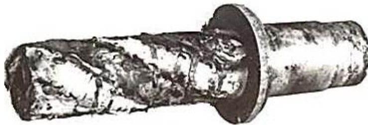
Рис. 2. Внешний вид концевой фрезы: а – заготовка под наплавку; б – наплавленный инструмент
