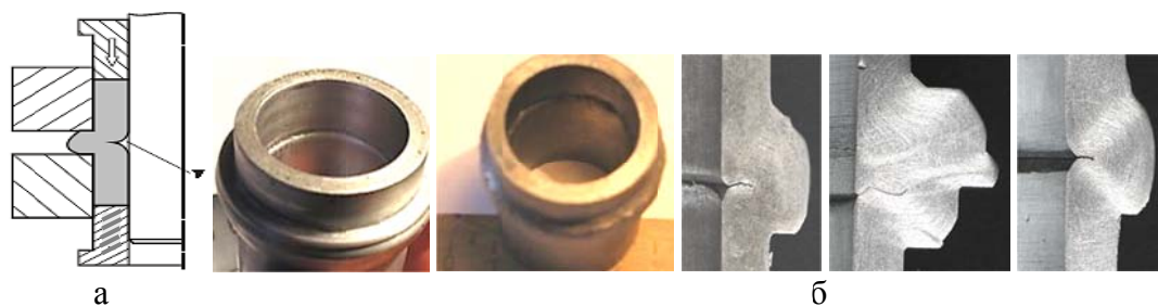
Рис. 1. Возникновение утяжины при радиальном выдавливании утолщения: схема деформирования (а) и детали с утяжиной (б)
