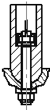
Рис. 2. Подшипник опорного круга портального крана
