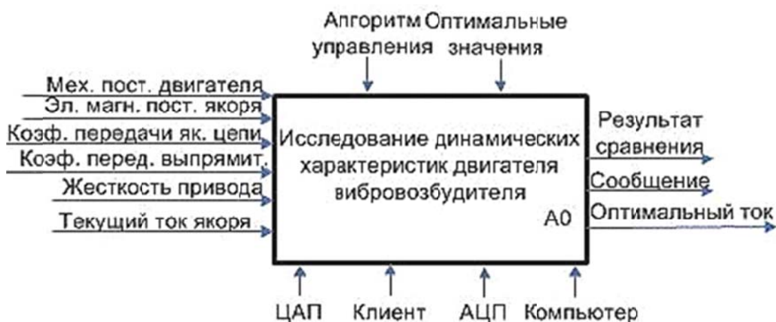
Рис. 1. Принципиальная структурная диаграмма для исследования динамических характеристик привода вибровозбудителя
