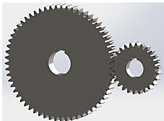
Рис. 3. Принятое некратное зубчатое зацепление z_1 = 26 , z_2 = 61 ; u = 2,346 ; x_1 = +0,35 ; x_2 = +0,1714
