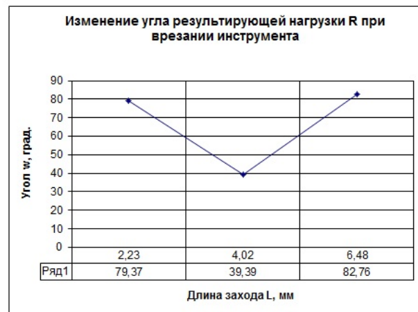
Рис. 2. Графики изменения вектора результирующей нагрузки R при засверливании и выходе инструмента
