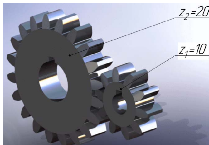
Рис. 1. Зубчатое зацепление с передаточным отношением u = 2 (кратное)
