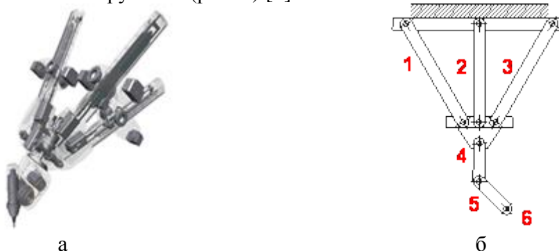
Рис. 4. Схема механизма, используемого для обработки зубчатых колес при помощи фасонного инструмента:
