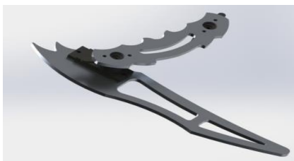
Рис. 5. Конструкция ноги гексапода
