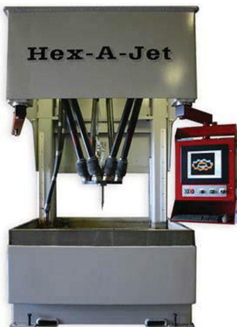
Рис. 1. Станок гексапод Р3000 фирмы Mikrolar (США)
