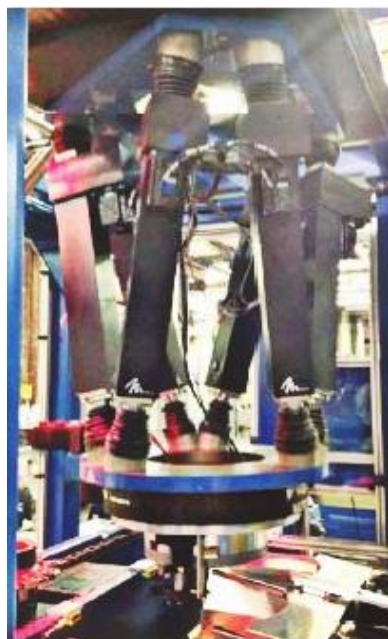
Рис. 2. Обрабатывающий модуль Р2100 фирмы Mikrolar (США)
