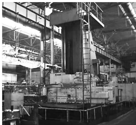
Рис. 1. Зовнішній вид горизонтально-розточувального верстата моделі Skoda W-200
