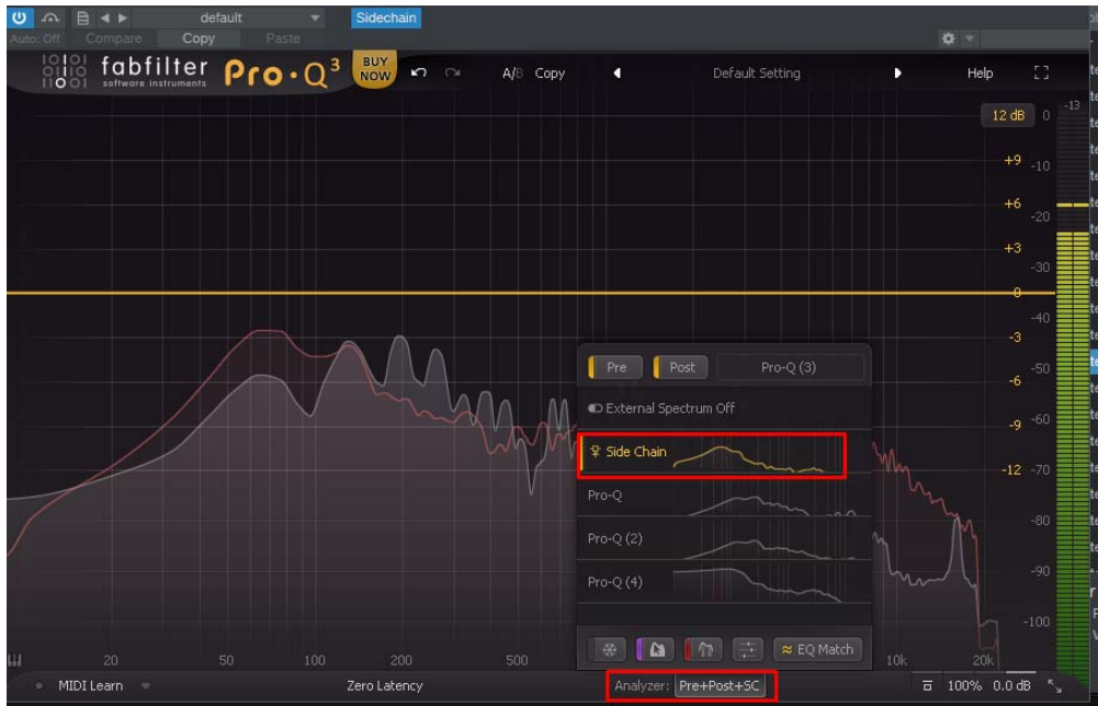
Рис. 2. Додавання частотної характеристики бас-бочки до графіка частотної характеристики бас-гітари
