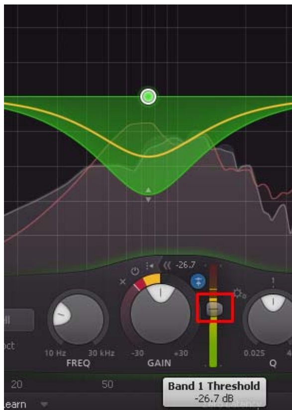
Рис. 4. Налаштування корекції сайдчейн бас-гітари від бас-бочки на частоті 75 Гц
