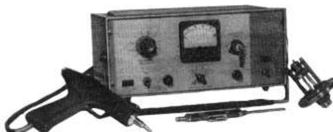
Рис.4.65. Галогенний течешукач ГТИ-6
