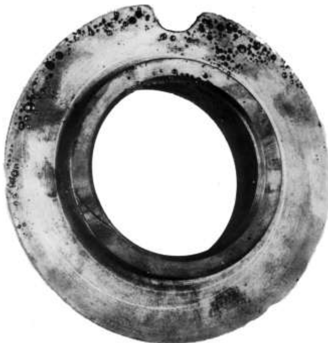
Рис.3.26. Дірчастість – неправильне розташування виливка, що має форму тіла обертання, в ливарній формі (табл.3.1, поз.3.12)
