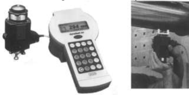
Рис.7.83. Твердомір DYNATEST та його використання
