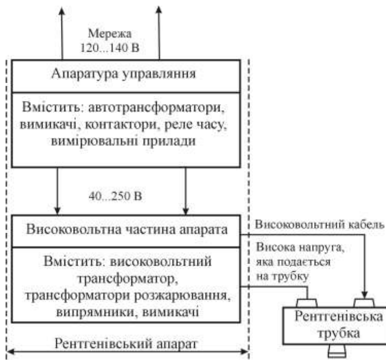
Рис.4.70. Структурна схема рентгенівської установки
