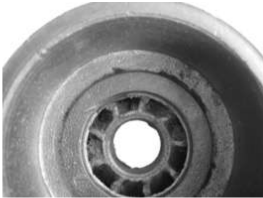
Рис.3.11. Пригар – недостатнє ущільнення формувальної суміші у важкодоступних місцях та висока температура металу перед заливанням його у форму (табл.3.1, поз.2.1)
