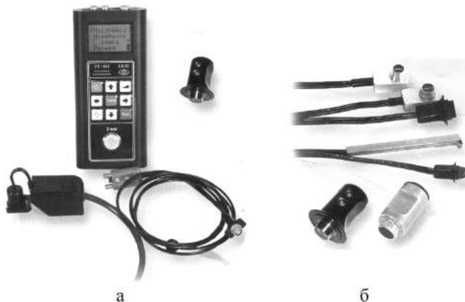
Рис.7.32. Загальний вигляд вимірювача товщини УТ-98Т „СКАТ” (а) і вимірювальні перетворювачі до нього (б)
