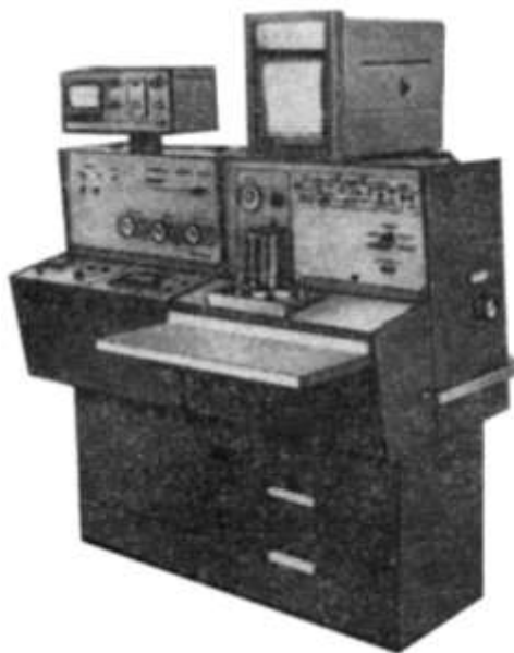
Рис.4.64. Течешукач гелієвий СТИ-11
