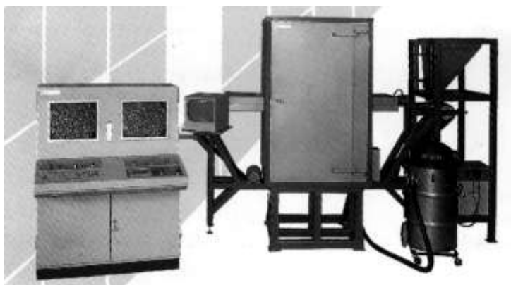
Рис.7.48. Комплекс для контролю металургійної продукції АРТИКОН ВСЛ
