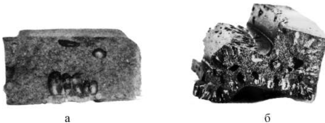
Рис.3.18. Газова раковина: а – мала газопроникність ливарної форми; б – наскрізна газова раковина – утворена надмірним газовиділенням ливарної форми (табл.3.1, поз.3.4)
