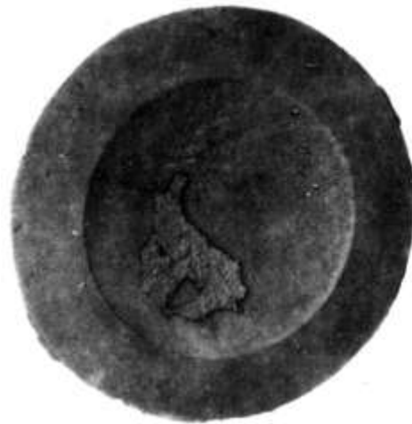
Рис.3.12. Ужимина – надмірна ущільненість формувальної суміші, внаслідок чого форма стала неспроможною сприймати теплове розширення кварцу без порушення цілісності поверхні (табл.3.1, поз.2.3)
