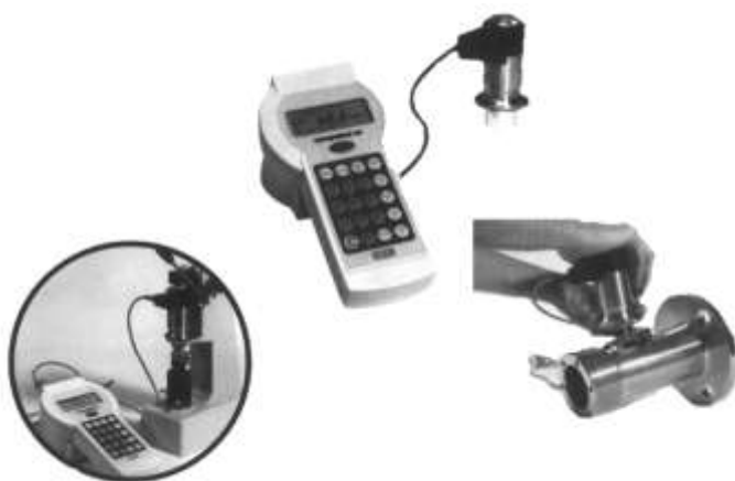
Рис.7.82. Портативний твердомір COMPUTEST та його використання
