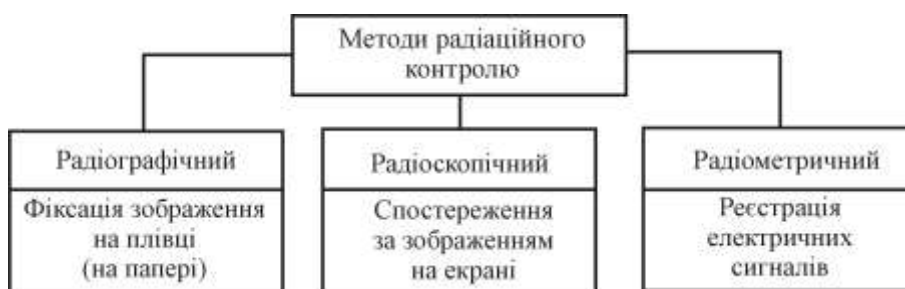
Рис.4.67. Класифікація методів радіаційного контролю
