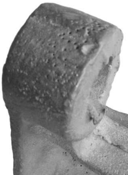
Рис.3.11. Пригар – недостатнє ущільнення формувальної суміші у важкодоступних місцях та висока температура металу перед заливанням його у форму (табл.3.1, поз.2.1)
