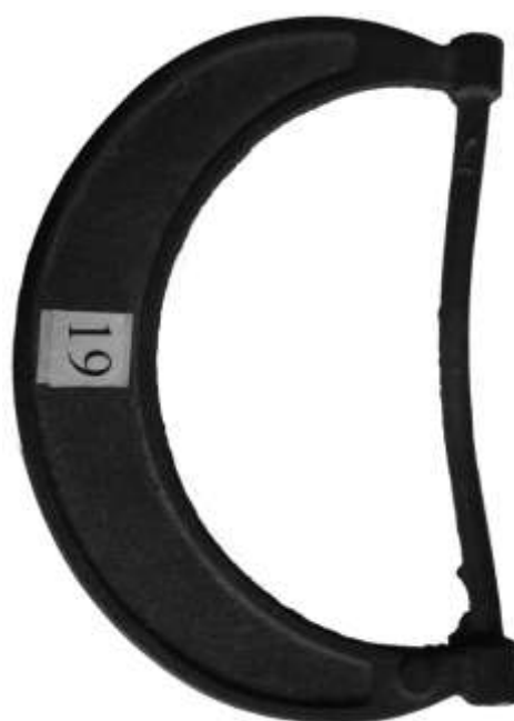
Рис.3.6. Жолоблення – невдала конструкція литої деталі та надмірно швидке охолодження виливка в ливарній формі (табл.3.1, поз.1.9)
