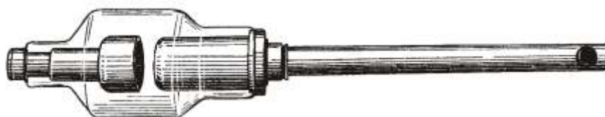
Рис.4.74. Рентгенівська трубка з винесеним порожнистим анодом
