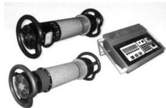
Рис.7.39. Рентгенівський апарат GE-IT-SEFERT
