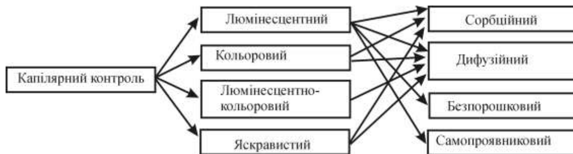
Рис.4.26. Різновиди капілярних методів неруйнівного контролю
