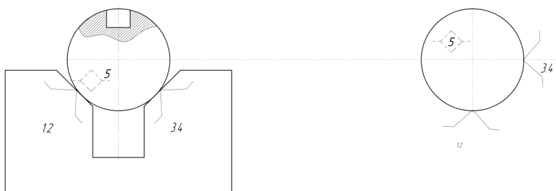
Рисунок 2.7 Схема базирования цилиндра на призме
