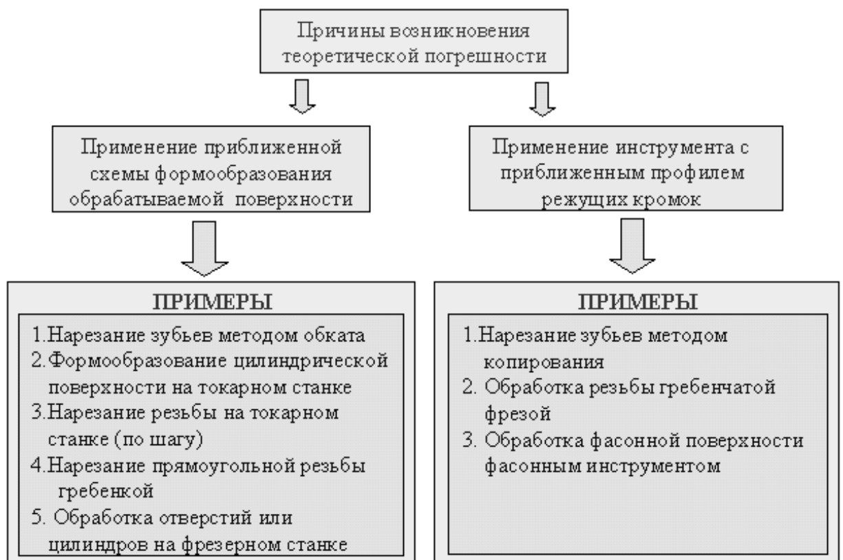
Рисунок 3.10 Примеры образования погрешностей от теоретической схемы обработки
